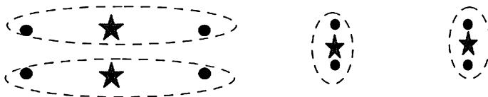
Рис. 5.14. Пример неудачной работы метода K -средних при поиске двух кластеров на множестве четырех точек плоскости: на правой стороне рисунка разделение с помощью K -средних логично, а на левой — нет (здесь центры обозначены звездами)
